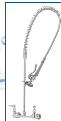
B-0133 Unité de pré-rinçage, 8" montage mural, valve de pulvérisa- tion 1.42 gpm, car- touches « Eterna »
